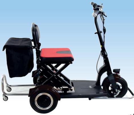
Der vordere, klappbare Bügel schützt vor Beschädigung und kann zum Tragen verwendet werden.
